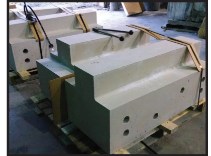
Forge Furnace Door Jambs
